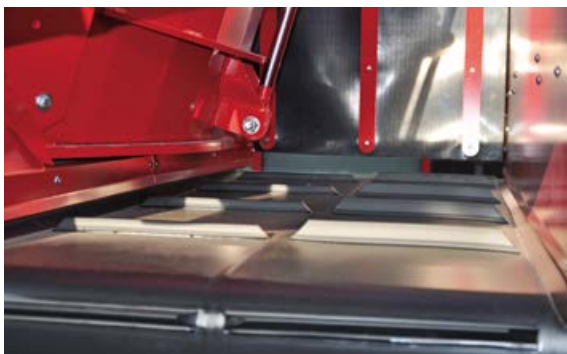
Поперечный ленточный транспортер SILOKING оснащен планками различной высоты, что увеличивает его продуктивность и надежность.
