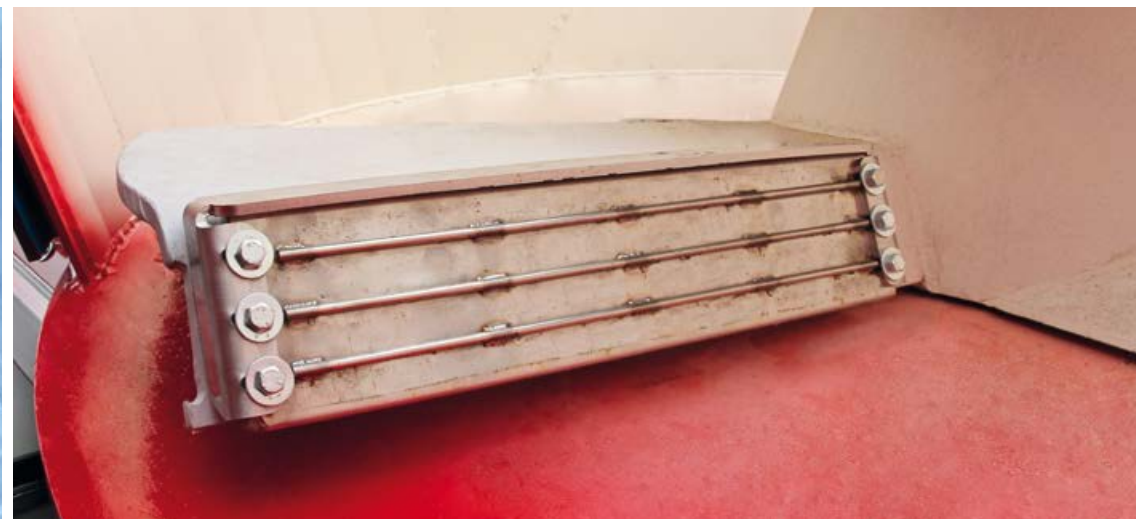
Высокомощный магнит на турбо-шнеке.
