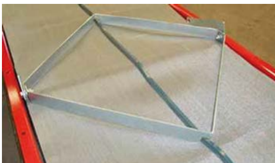
Ромбовидный скребок, расположенный снизу, очищает транспортер и гарантирует долговечность.
