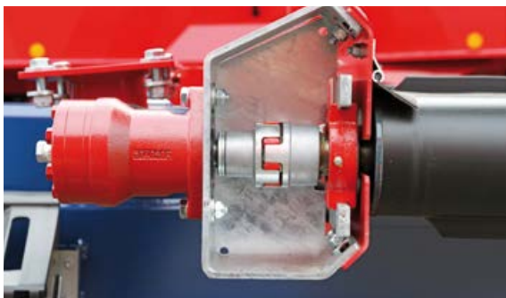
Сцепление между приводным двигателем и валом обеспечивает плавный ход и долгий срок службы.
